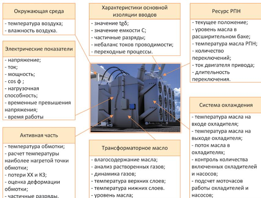
Рис. 7. Пример параметров силового трансформатора, контролируемых системой мониторинга [10]
