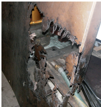
Рисунок 1: Результат воздействия ЧР на внутреннюю изоляцию силового трансформатора
