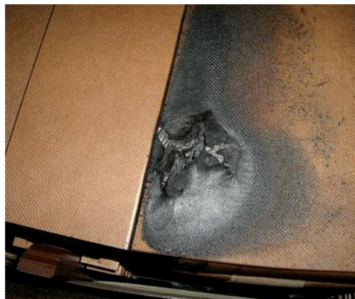
Рисунок 1: Результат воздействия ЧР на внутреннюю изоляцию силового трансформатора
