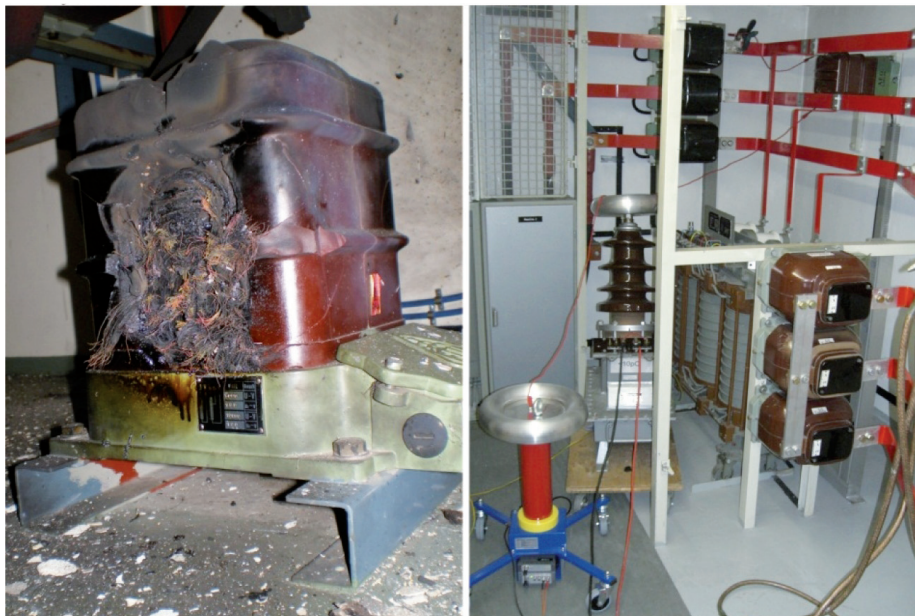
Рисунок 9. Неисправный ТТ и испытания на ЧР на аналогичном ТТ
