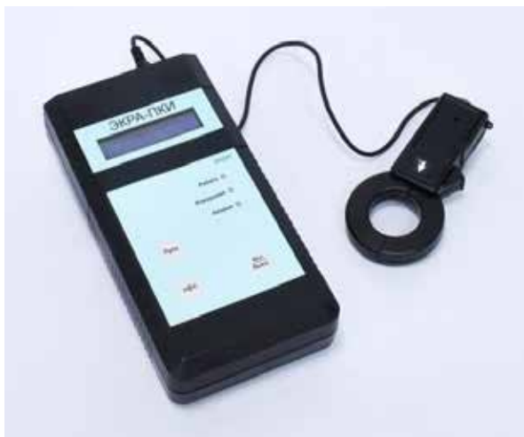
Рис. 3. Переносное устройство поиска присоединений с поврежденной изоляцией ЭКРА-ПКИ
