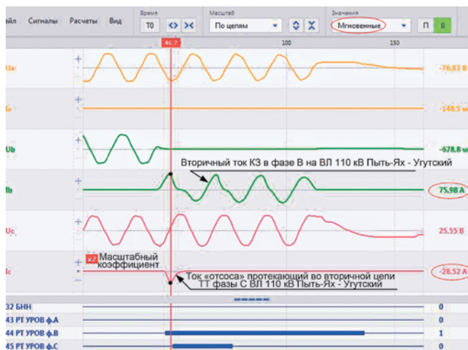
Рис. 2. Осциллограмма терминала АУВ ВЛ «Пыть-Ях» при КЗ в фазе В
