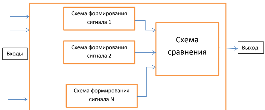
Рис. 2. Схема измерительного органа релейной защиты
